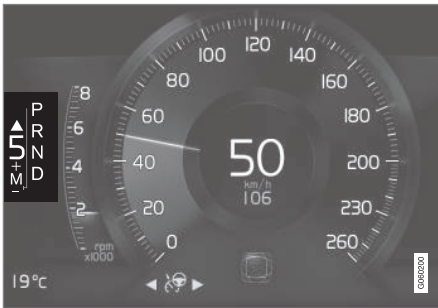
Indikace řazení na 8" displeji řidiče u velké řadičí páky.
