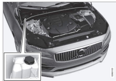
Vyrovnávací nádržka chladicí kapaliny, vozidlo s levostřanným řízením
