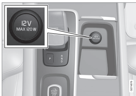
Přední elektrická zásuvka konzole tunelu u vozidel bez bezdrátové nabíječky telefonů*.
