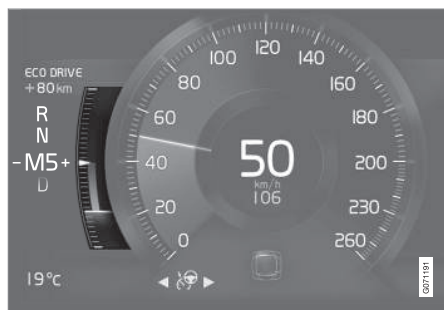
Indikace Eco na 8" displeji řidiče.
