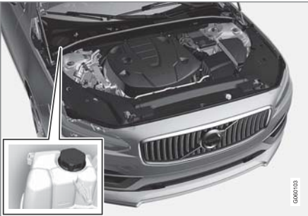
خزان التمدد لسائل التبريد، سيارة ذات عجلة قيادة يسرى
