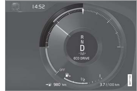
مقياس Eco في شاشة السائق قياس ١٢ بوصة*.
