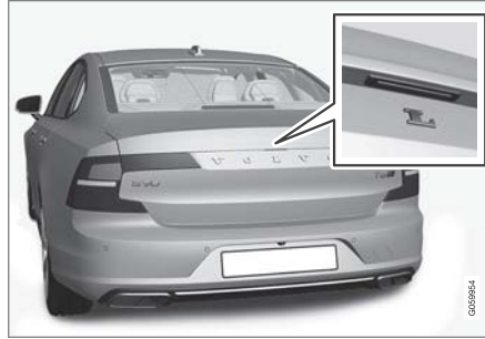
يمكن استخدام اللوحة المطاطية الانضغاطية على باب صندوق الأمتعة لفتح القفل فقط.
