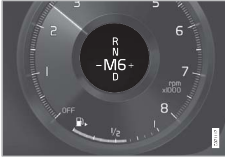
مؤشر تعشيق التروس في شاشة السائق قياس ١٢ بوصة، في حالة ذراع تغيير التروس الصغير*.
