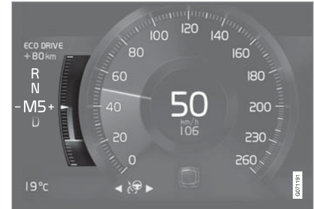
مقياس Eco في شاشة السائق قياس ٨ بوصة.
