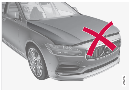
Kapota motora nie je úplne zatvorená.
