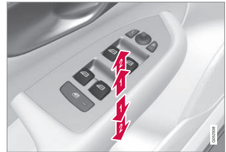
Elektrické ovládanie okien.
