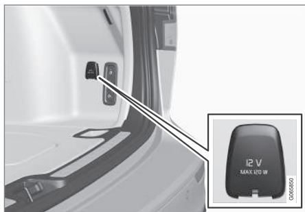
12 V elektrická zásuvka v batožinovom priestore*.
