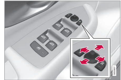
Ovládače vonkajších spätných zrkadiel.
