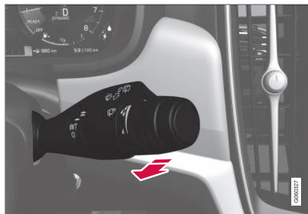
Funkcia umývania, pravý pákový spínač.
