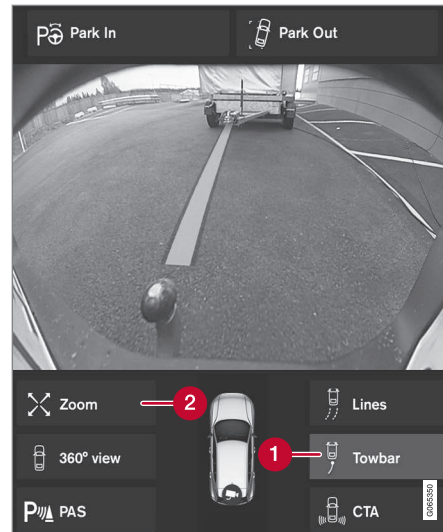
Ťažné zariadenie s čiarou parkovacieho asistenta
