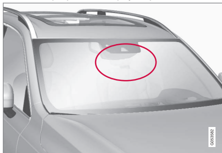
Umiejscowienie modułu radarowego
