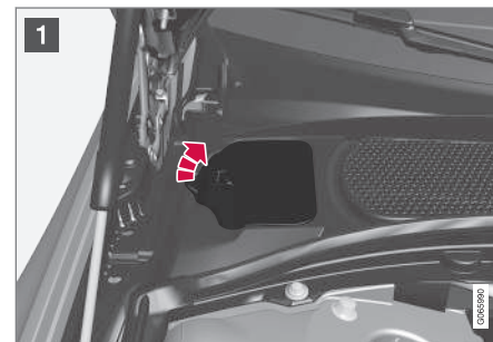
Zbiornik wyrównawczy płynu chłodzącego
