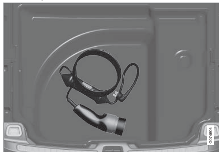
Įkrovimo kabelis laikomas skyriuje po bagažinės grindų dangčiu.
