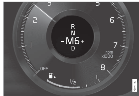
Pokazatelj izbrane prestave za 12-palčni voznikov zaslon za majhno prestavno ročico*.
