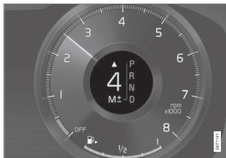
Pokazatelj izbrane prestave za 12-palčni voznikov zaslon za veliko prestavno ročico*.
