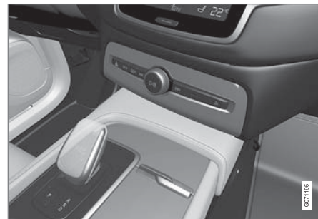
ギヤセレクターインヒビターを非作動状態にすることができない小型セレクターレバーの概観
