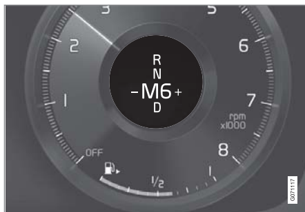
12 インチドライバーディスプレイの小型セクターレバー*用ギヤシフトインジケーター
