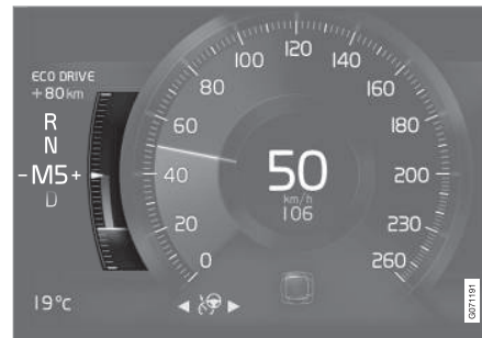
Compteur ECO sur l'écran conducteur 8 pouces.
