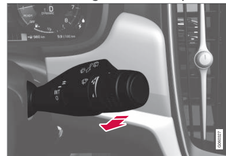
Fonction lave-glace, levier droit au volant
