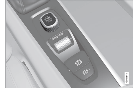
Commande de démarrage sur la console de tunnel.
