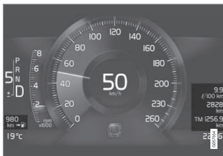
Exemple d'informations de l'ordinateur de bord sur l'écran conducteur de 8 pouces. L'illustration est schématisée, les détails peuvent varier selon le modèle de la voiture.
