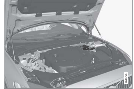
توجد بطارية الدعم قوة ١٢ فولت في حجرة المحرك.
