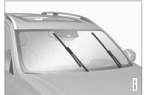
Balais d'essuie-glace en position d'entretien.
