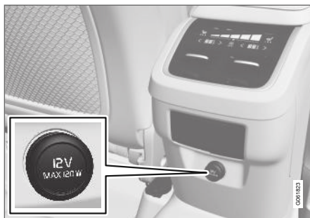
12 voltos elektromos aljzat az alagút-konzolban, hátsó ülés.
