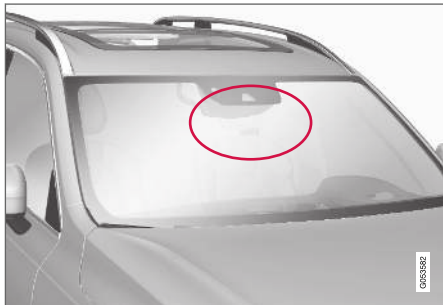
A kamera egység elhelyezkedése.
