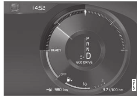
Eco műszer a 12-hüvelykes járművezetői kijelzőn*.
