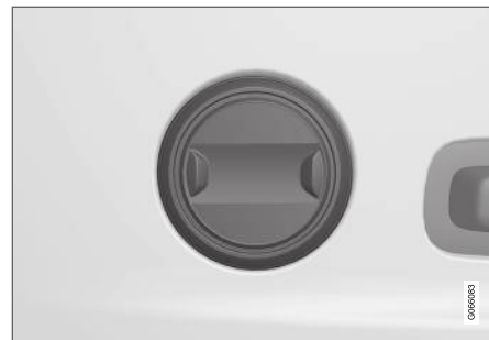
Kezelőszerv kétutas deréktámasszal* rendelkező autókban.
