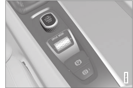
Indító gomb az alagútvezérlőn.
