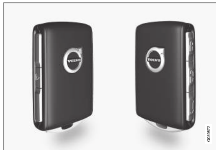
A távezerlős kulcs négy gombbal rendelkezik - eggyel a bal oldalon és hárommal a jobb oldalon.
