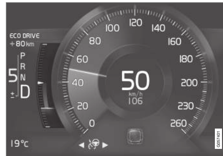
Eco műszer a 8-hüvelykes járművezetői kijelzőn.
