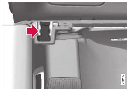
Gniazdo diagnostyczne (On-board Diagnostic, OBDII) znajduje się pod tablicą rozdzielczą po stronie kierowcy.
