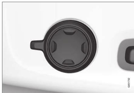
Többfunkciós kezelőszerv négyutas deréktámasszal* rendelkező autókban.
