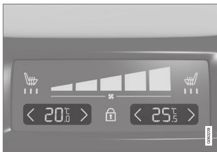
Hőmérséklet-vezérlés az alagútvezető hátsó klímapaneljén.
