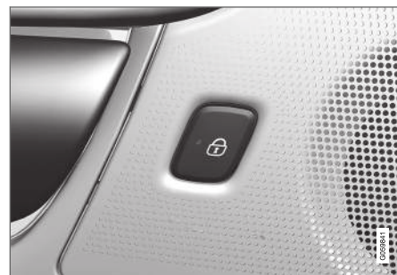
Záró gomb visszajelző lámpával a hátsó ajtóban.
