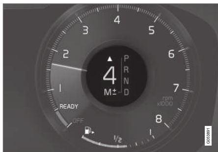
Fokozatváltás-jelző a 12-hüvelykes járművezetői kijelzőn*.
