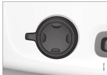
Többfunkciós kezelőszerv, az ülés ülőrésének oldalán.
