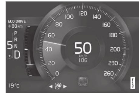
Eco műszer a 8-hüvelykes járművezetői kijelzőn.
