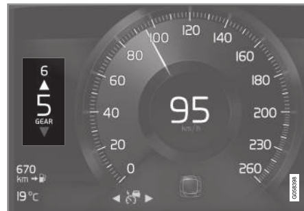
Fokozatváltás-jelző a 8-hüvelykes járművezetői kijelzőn.
