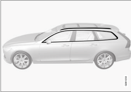
Alkatrészek, amelyek 3,5 és 11,5 pH-érték közötti tisztítószerrel moshatók.
