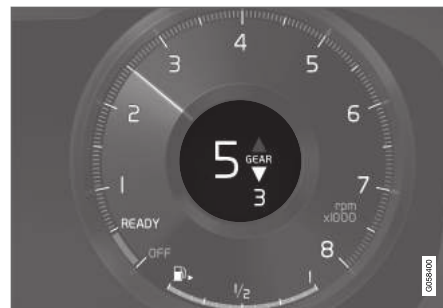
Fokozatváltás-jelző a 12-hüvelykes járművezetői kijelzőn*.
