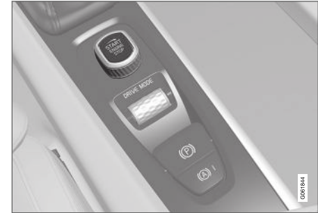
Tünel konsolundaki çalıştırma düğmesi.
