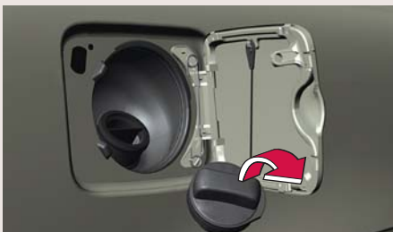
Den Tankverschluss beim Tanken aufhängen.
