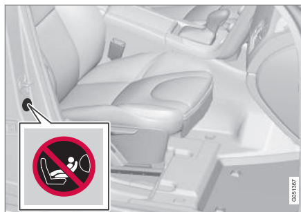
Alternativ 2: Placering av krockkuddens dekal på passagerarsidans dörrstolpe. Dekalen blir synlig när passagerardörren öppnas.
