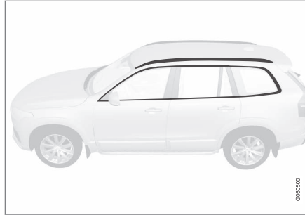
Alkatrészek, amelyek 3,5 és 11,5 pH-érték közötti tisztítószerrel moshatók.
