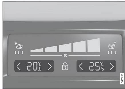
Hőmérséklet-vezérlés az alagút konzol hátuljának klímpaneljén.
