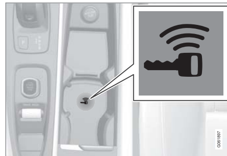
備用讀取器位於中央扶手控制台中。
