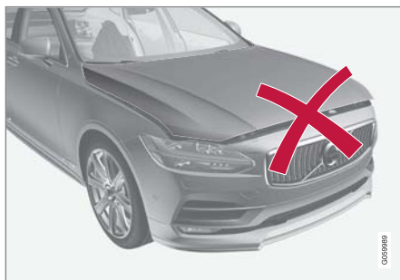
引擎蓋並未完全關閉。
