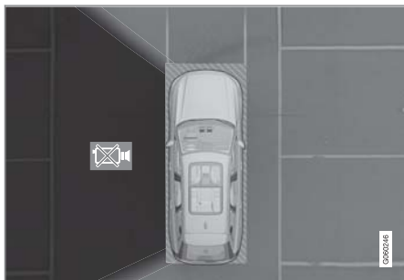
車輛左側攝影機故障。
