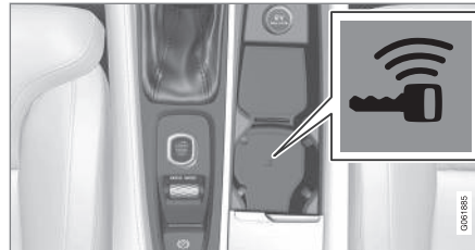
Umiestnenie záložnej čítačky v držiaku pohárov.
