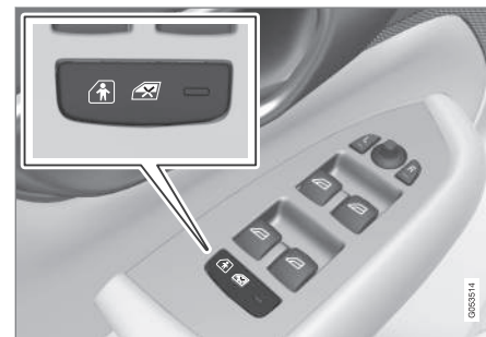
Tlačidlo elektrického aktivovania a deaktivovania.
