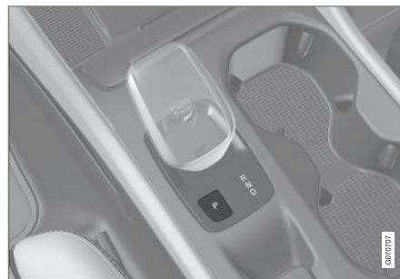
Prehľad radiacej páky a polohy P.
