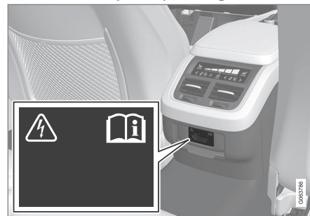
Strømuttak i tunnelkonsollen i baksetet.
