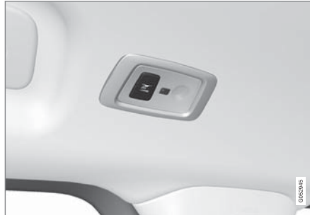
파노라마 선루프*가 장착된 차량에는 루프의 양쪽에 하나씩 두 개의 램프 유닛이 있습니다.
