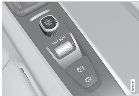
Startvredet i tunnelkonsolen.
