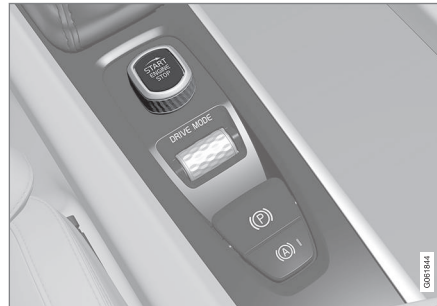
Startvredet i tunnelkonsolen.
