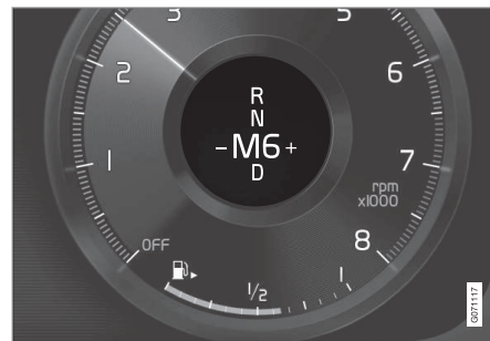
Pārsenumu pārslēgšanas indikators 12 collu vadītāja displejā mazajai pārsenumsvirai*.
