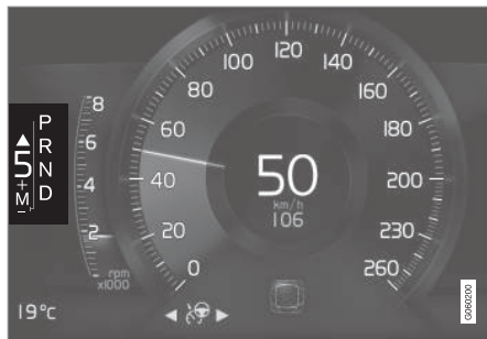
Pārsenumu pārslēgšanas indikators 8 collu vadītāja displejā mazajai pārsenumsvirai.
