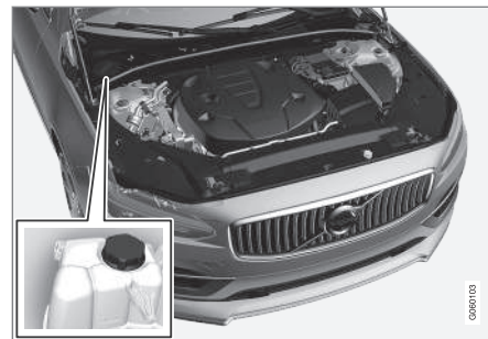
Hűtőfolyadék tágulási tartálya, balkormányos autó
