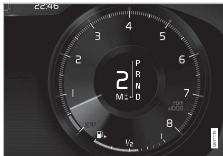
A váltási minta áttekintése a járművezetői kijelzőn nagy sebességváltó kar esetén.
