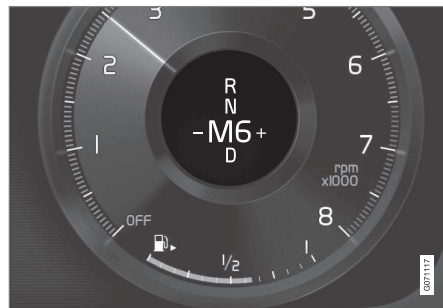
A váltási minta áttekintése a járművezetői kijelzőn kis sebességváltó kar esetén.
