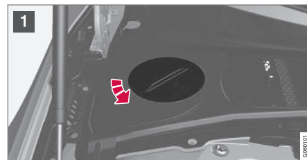
Hűtőfolyadék tágulási tartálya, balkormányos autó
