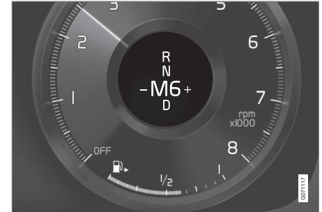
Indicateur de rapport sur l'écran conducteur 12 pouces, pour petit levier de vitesse*.
