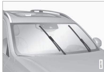
Balais d'essuie-glace en position d'entretien.
