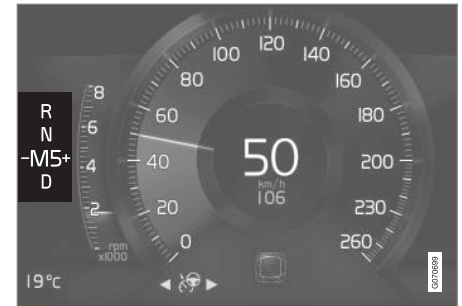
Indicateur de rapport sur l'écran conducteur 8 pouces, pour petit levier de vitesse.
