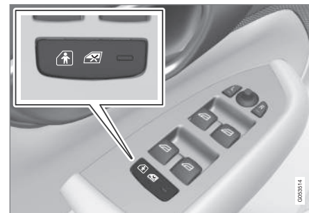
Bouton d'activation et de désactivation électrique.
