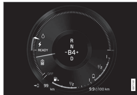
Displej vodiča indikuje nabíjanie počas brzdzenia elektromotorom.
