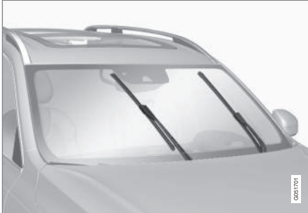
Balais d'essuie-glace en position d'entretien.
