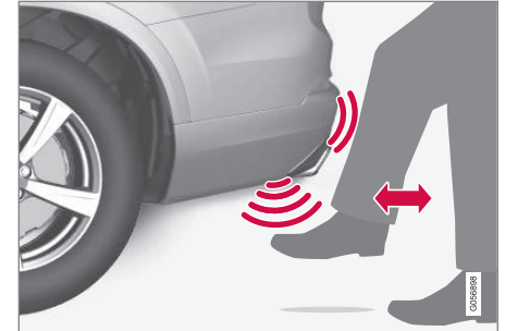
Mouvement du pied dans la zone d'activation du capteur.
