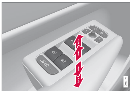
Regulering av vindusheiser.
