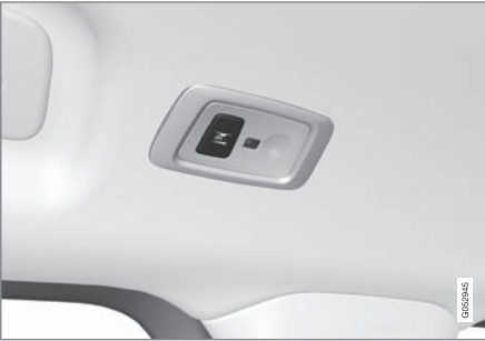
في السيارات المزودة بسقف بانوراما* توجد وحدات ومصباح واحدة في كل جهة من جهتي السقف.
