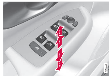
Elektrické ovládanie okien.
