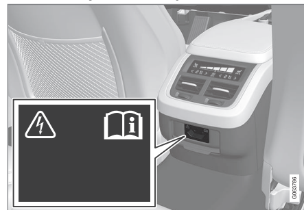
Elektrická zástrčka v stredovom tuneli, zadné sedadlo.
