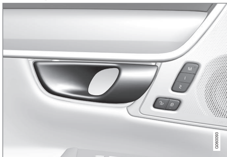
Klamka do alternatywnego odblokowania w drzwiach bocznych 11 .
