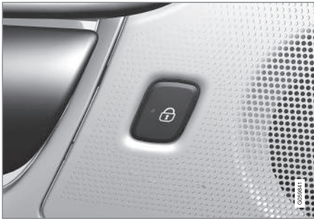
Låseknapp med indikatorlampe i bakdør.
