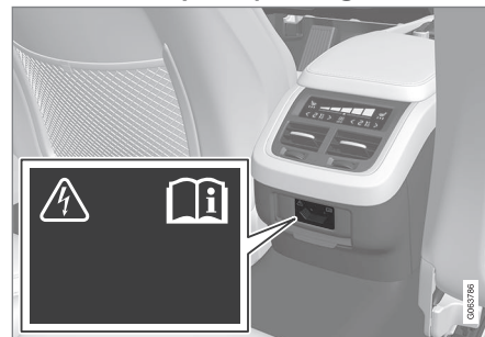
Strømuttak i tunnelkonsollen i baksetet.
