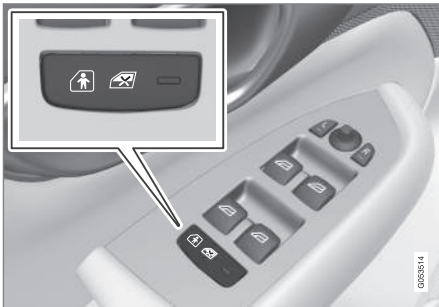
Knapp for elektrisk aktivering og deaktivering.
