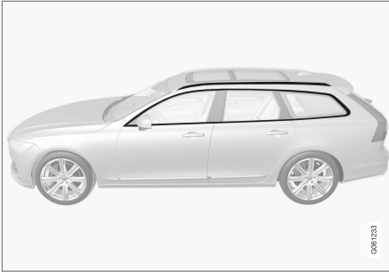
Alkatrészek, amelyek 3,5 és 11,5 pH-érték közötti tisztítószerrel moshatók.
