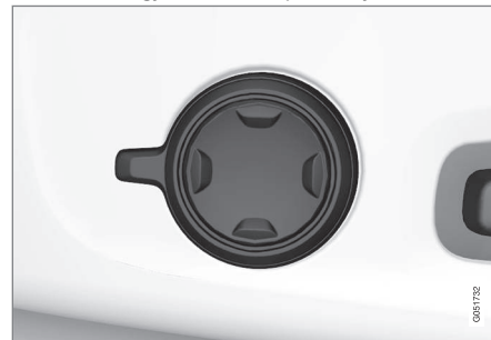
Többfunkciós kezelőszerv, az ülés ülőrésének oldalán.
