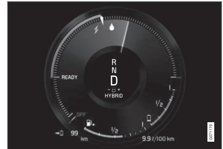
A meghajtás járművezetői kijelzője elektromos motorral és belsőégésű motorral.
