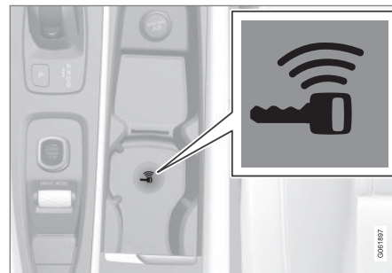
Umístění záložní čtečky v tunelové konzole.
