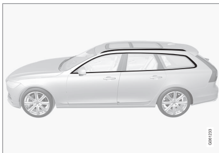
Díly, které by se měly mýt čistícím prostředkem s hodnotou pH mezi 3,5 a 11,5.
