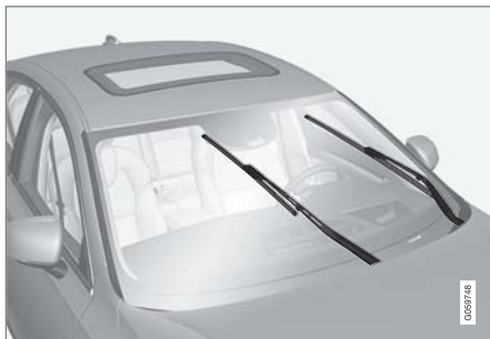
位於維修位置的雨刷片。
