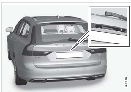
尾門上的橡膠壓板只能用於開鎖。
