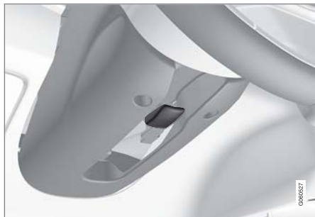
在配有膝部防護氣囊的車輛中調整方向盤
