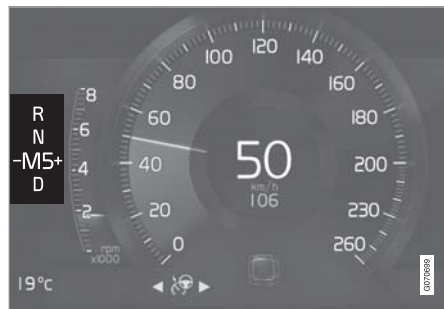
小型排檔桿的 8 吋駕駛人顯示器中的換檔指示器。
