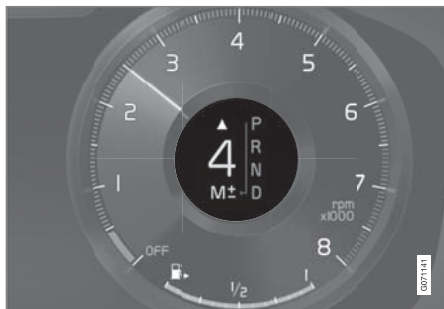
大型排檔桿的 12 吋駕駛人顯示器中的換檔指示器*。
