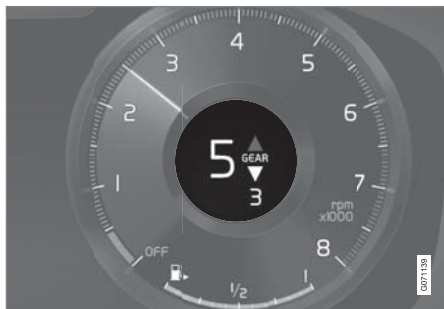
12 吋駕駛人顯示器*中的換檔指示器。
