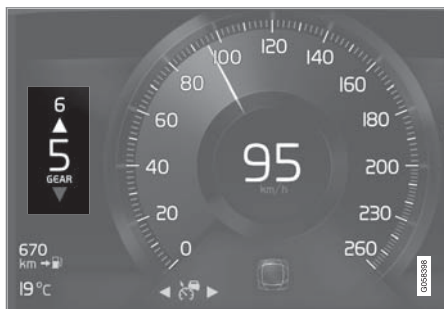
8 吋駕駛人顯示器中的換檔指示器。
