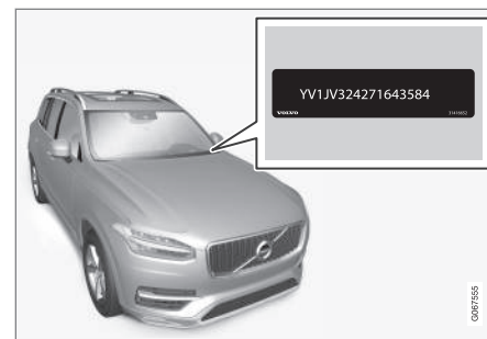
VIN visos modeļos atrodas līdzīgā vietā.
