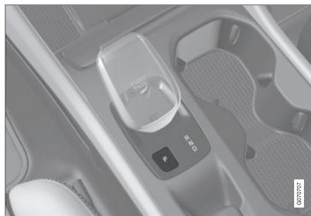
Pārnesumu pārslēgšanas un pozīcijas P pārskats mazajai pārnesumu pārslēgšanai.
