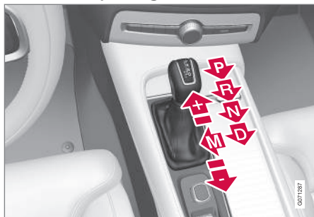
Lielās pārnesumu pārslēgšanas un pārnesumu pozīciju pārskats.
