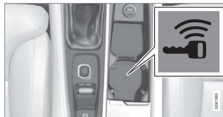
備用讀取器位於中央扶手控制台中。
