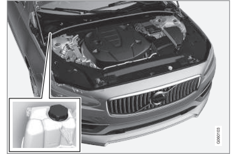
Dzesēšanas šķidruma izplešanās tvertne, automašīna ar stūri kreisajā pusē
