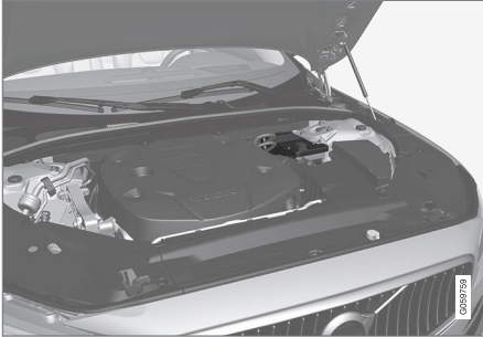
12 V atbalsta akumulators atrodas kastē blakus statnim.
