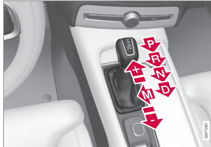
Vue d'ensemble du gros levier de vitesses et des positions de rapport.
