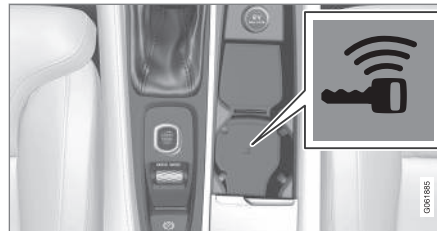
Umiestnenie záložnej čítačky v držiaku pohárov.
