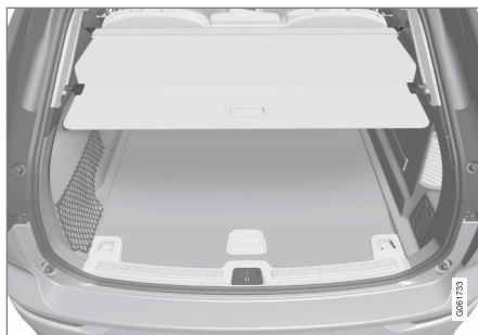
Zasłona bagażnika w położeniu pełnej osłony.
