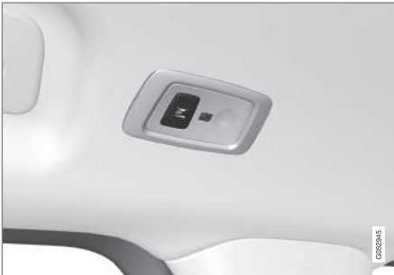
W samochodach z panoramicznym oknem dachowym* są dwa moduły lampek, po jednym z każdej strony sufitu.
