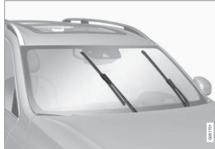
Pióra wycieraczek w pozycji serwisowej.
