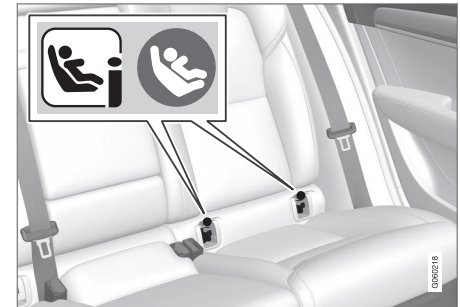
Umístění montážních bodů poznáte podle symbolů 2 na čalounění opěradla.
