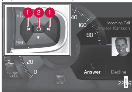
Przykłady komunikatów na wyświetlaczu kierowcy 4 i prawy zestaw przycisków na kierownicy.
