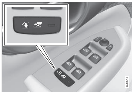
Przycisk do elektrycznej aktywacji i dezaktywacji.
