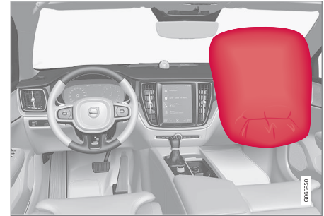
Czołowa poduszka powietrzna pasażera przedniego fotela.
