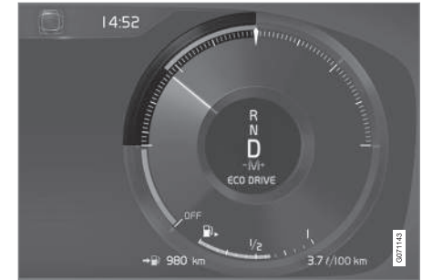
Wskaźnik ECO na 12-calowym wyświetlaczu kierowcy*.
