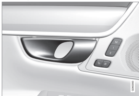
Klamka do alternatywnego odblokowania w drzwiach bocznych 11 .
