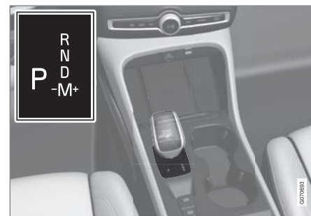
小型セレクターレバーおよびドライバーディスプレイのシフトパターンの概観
