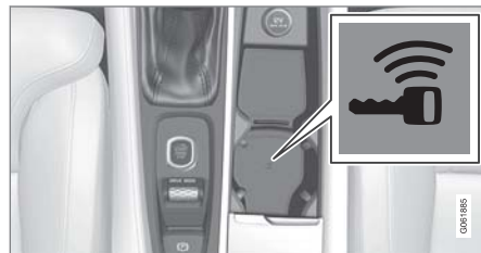
トンネルコンソール内のバックアップリーダーの場所
