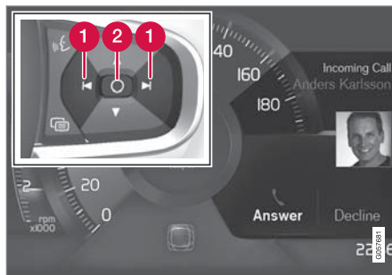
ドライバーディスプレイ 4 のメッセージの例とステアリングホイール右側のステアリングリモコン
