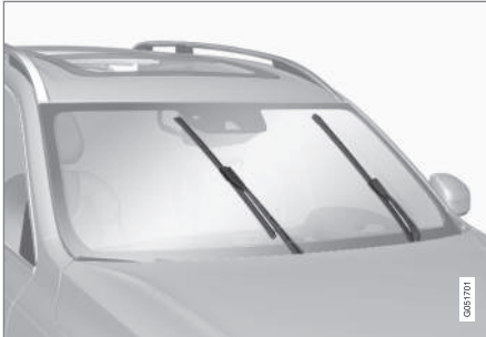
Balais d'essuie-glace en position d'entretien.
