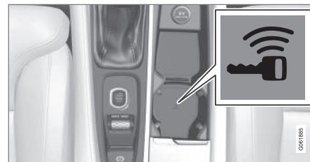
Расположение резервного считывающего устройства в тоннельной консоли.
