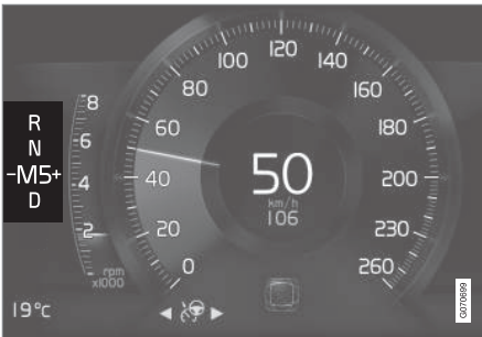
Индикатор переключения для передач на 8-дюймовом дисплее водителя для компактного рычага переключения передач.
