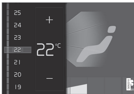
Commande de température.
