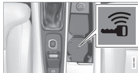
Umístění záložní čtečky v tunelové konzole.
