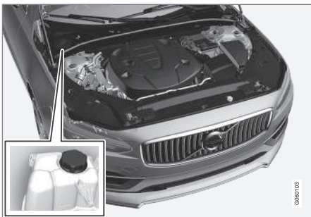
Hűtőfolyadék táglási tartálya, balkormányos autó
