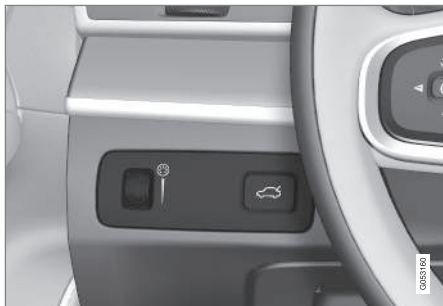
Forgókapcsoló (balra) a belső fényerő beállításához.
