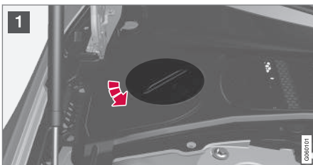
Hűtőfolyadék táglási tartálya, balkormányos autó
