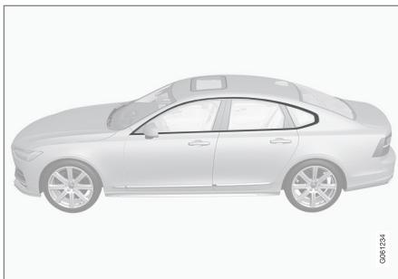
Alkatrészek, amelyek 3,5 és 11,5 pH-érték közötti tisztítószerrel moshatók.
