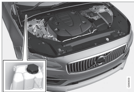
Hűtőfolyadék táglási tartálya, jobbkormányos autó
