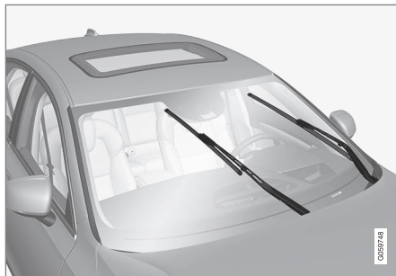
Az ablaktörlő lapátok a szervizállásban.
