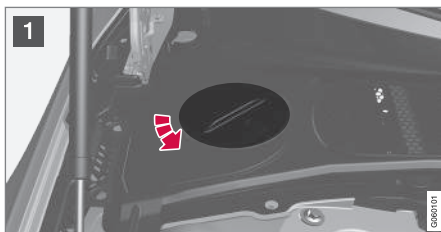
Vase d'expansion du système de refroidissement, voiture à conduite à gauche
